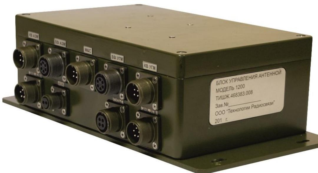
Рисунок 1.1 – Внешний вид БУА 1200 со стороны левой боковой и нижней стенки изделия
