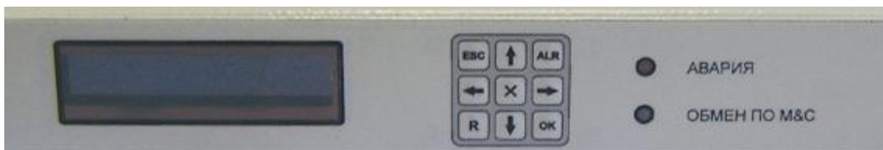
Рисунок 2.4 - Внешний вид органов контроля и управления БУА 1200, расположенных на ПУ БУА
